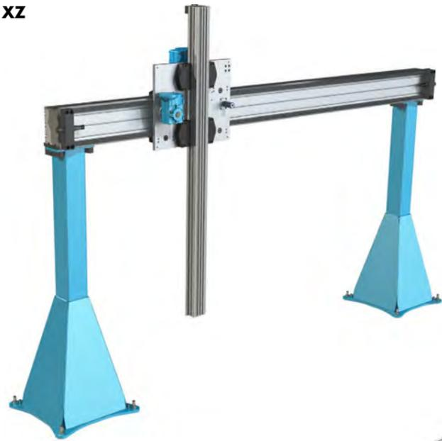
标准Hepco龙门桁架系统基于HDS2重型系列。双轴拾取和放置龙门桁架是产品搬运应用中最常见的配置。两轴均由安装在单个双轴托架组件上的高负载精密齿条和小齿轮驱动。自动润滑通过一个单独的可拆卸润滑小齿轮将润滑脂涂抹到齿条上。刮擦器可以加注润滑剂，以实现长达100000km的使用寿命。有关系统设计和功能的更多信息，请访问[8-11](#)。
